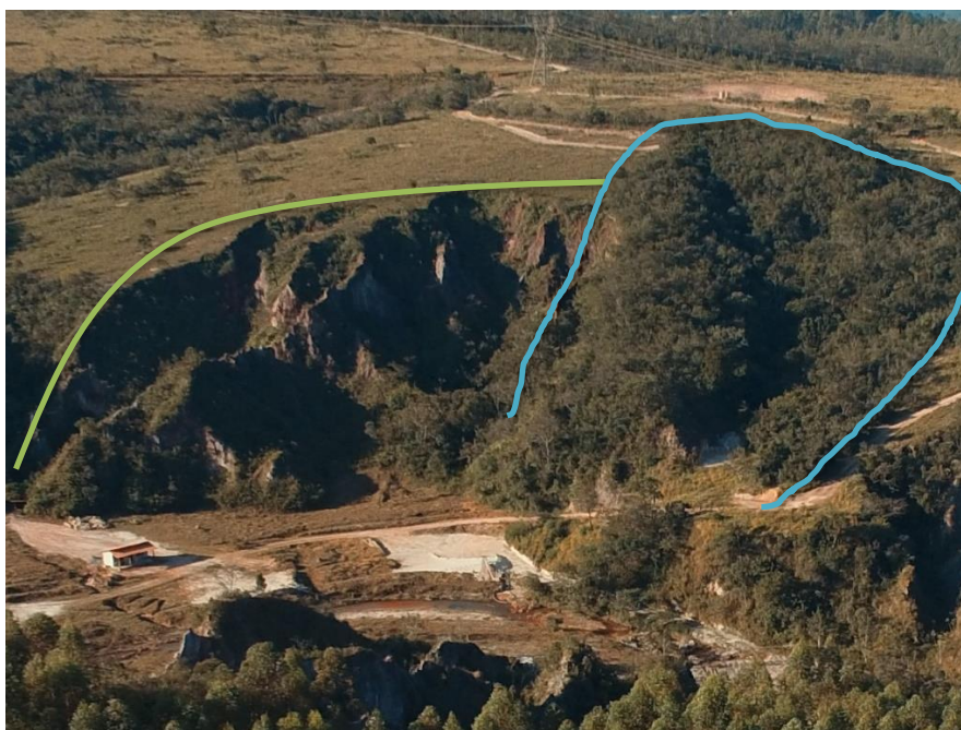
Figura 14 - Detalhe da imagem anterior, destacando voçoroca estabilizada por ações de revegetação realizadas por proprietário rural (indicado pela linha verde) e voçoroca recuperada (linha azul). Fonte: MYR Projetos Sustentáveis, 2019
