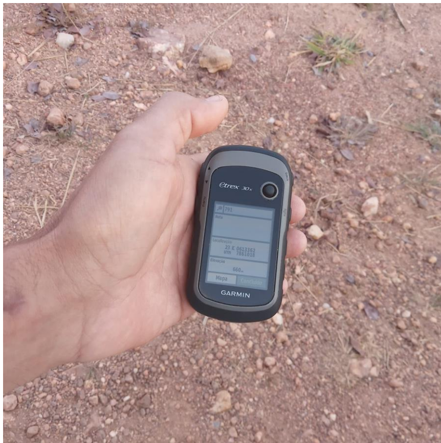
Figura 5.1 – GPS Utilizado no Levantamento Topográfico
